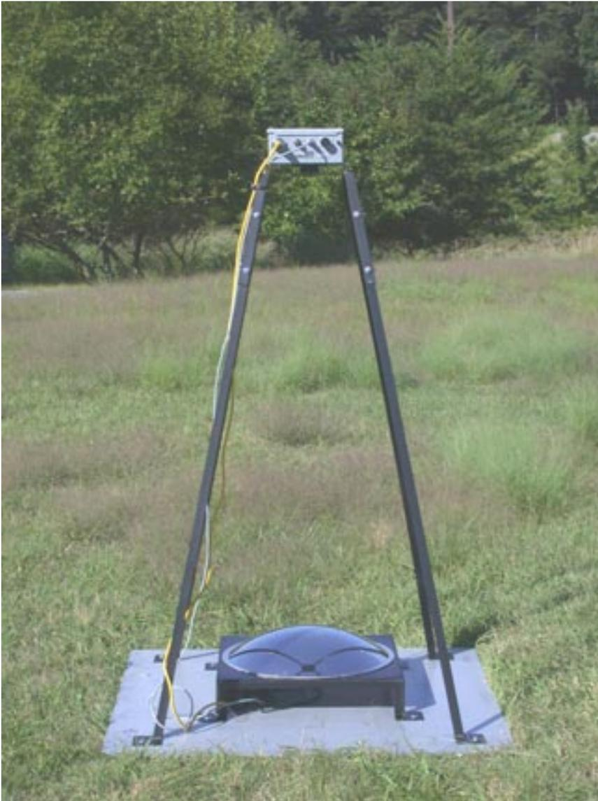
**FIGURE 2. INFRARED SKYCAMERA**
